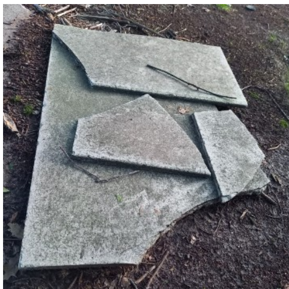
Figuur 24: Voorbeeld van een niet-constructie: stukken van platen in vezelcement (afval)
